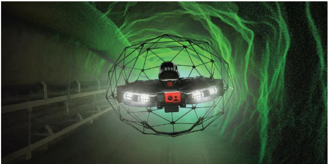
ELIOS 3 は、世界初の屋内3D マッピング用 LiDAR センサーと、飛行空間をリアルタイムに3D モデル化する SLAM エンジン「FlyAware<sup>TM</sup>」<sup>※3</sup> を搭載しており、点検対象箇所・施設の多角的かつ高精度なデータ取得と、空間情報の 3D 化によるドローン周辺環境の容易な把握、それによるドローン操作の簡易化と高い安定飛行性を実現しました。
