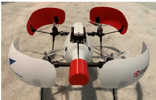
移動通信中継局搭載ドローン 参考展示品
