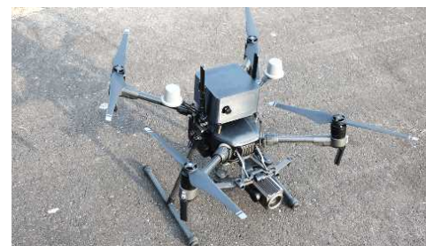
<対象物検知センサー搭載ドローン> 上部に取り付けられたモジュールが送電線の検知および機体・振動の制御を行う
