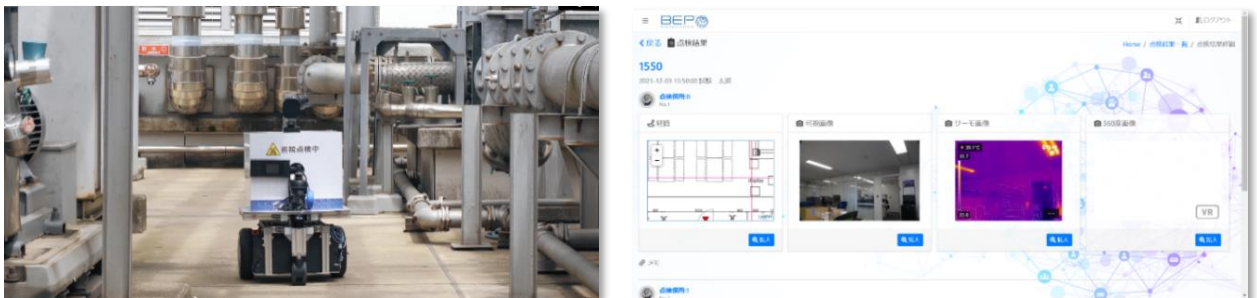
施設内を自動巡回する AGV(左)と「BEPサーベイランス」の管理画面(右)
