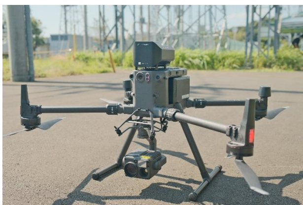
「BEP ライン」センサーモジュールを搭載したドローン(左)専用アプリケーション画面(右)
