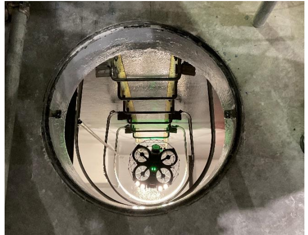
初めての操縦でも簡単に 狭い地下ピット内に入れることが可能
