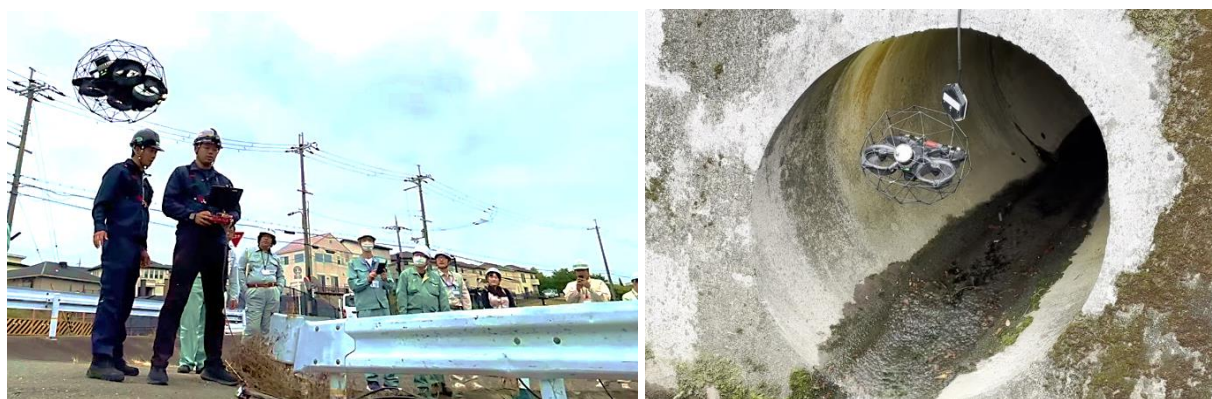
大阪府富田林市での技術検証の様子(左)と管渠に進入する ELIOS 3(右)
