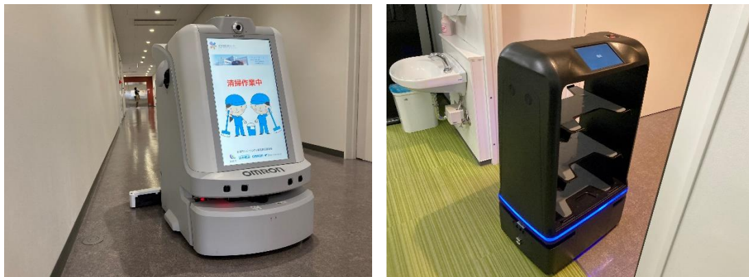
セキュリティ自動ドアなどの建物設備と連動し、清掃や配送を行うロボットの様子
